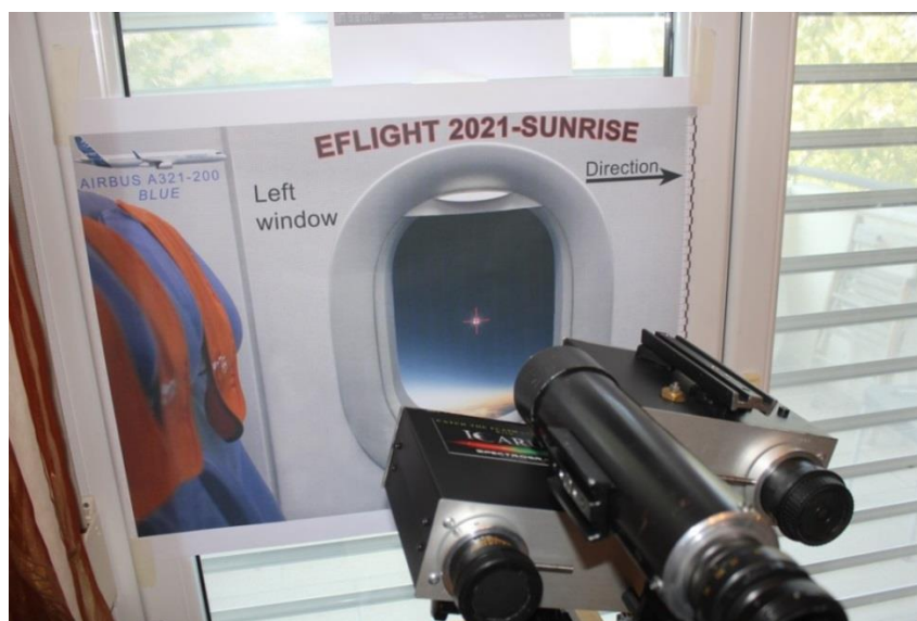
Εικόνα 1: Εξομοίωση των διαστάσεων και της θέσης ενός παραθύρου αεροσκάφους Airbus A-321 κατά τη σχεδίαση των βάσεων των φασματογράφων
