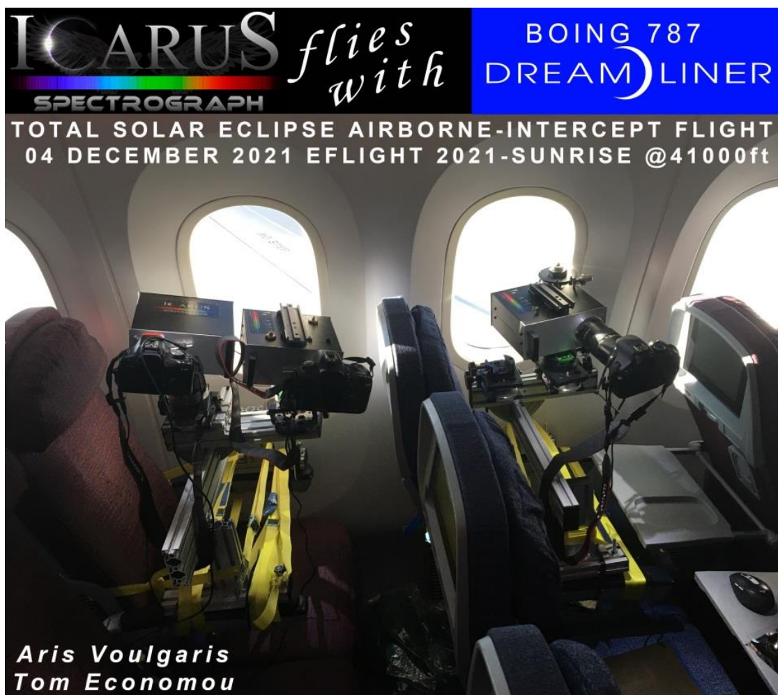
Εικόνα 8: 20 λεπτά πριν την έναρξη της ολικής έκλειψης τοποθετήθηκαν οι τρεις φασματογράφοι Icarus στις βάσεις τους.
