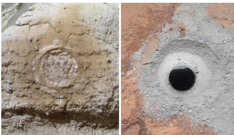
Εικόνα 12: Αριστερά: Αποτελέσματα από το εργαλείο τριβής του Opportunity. Δεξιά: Αποτελέσματα από το τρυπάνι του Curiosity.
