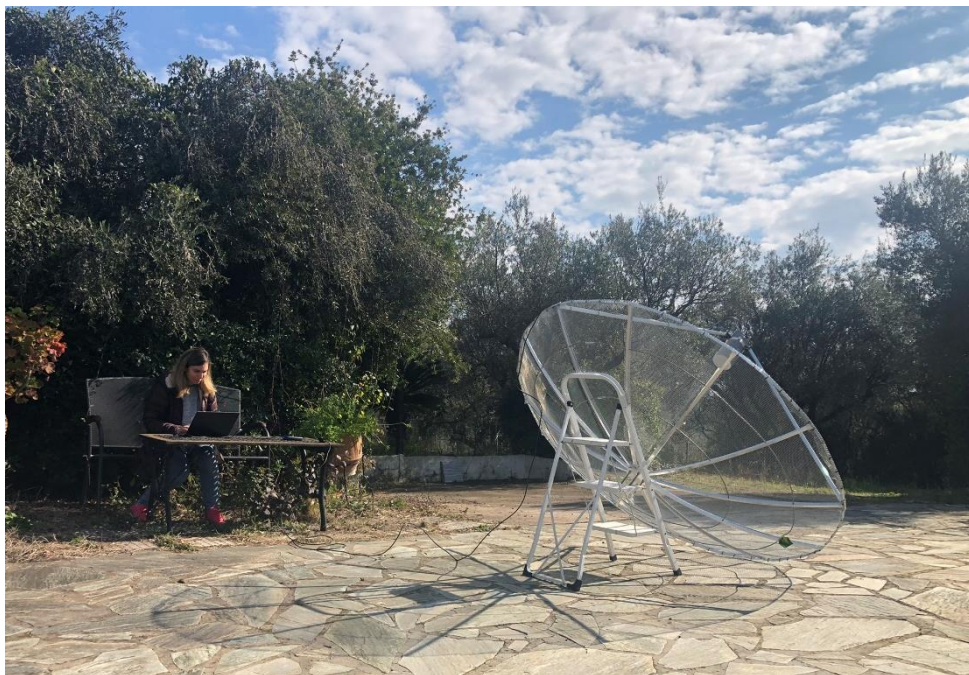
Εικόνα 7. Ραδιοτηλεσκόπιο σε πλήρη λειτουργία για καταγραφή ραδιοκυμάτων από τον ήλιο.
