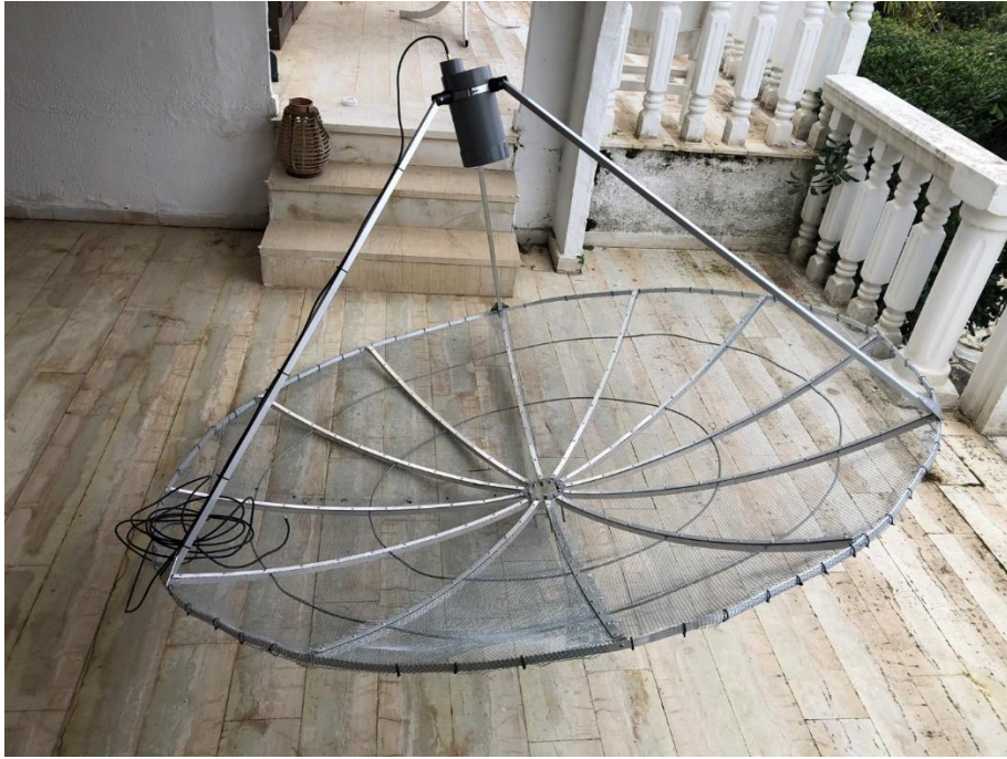
Εικόνα 5. Το συναρμολογημένο κεραιοσύστημα με τοποθετημένο feed
